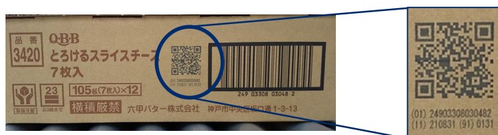
商品の段ボールケースに印字されたGS1 QRコード (GTIN、賞味期限、製造日、ロット番号、ケース番号が表されている)
