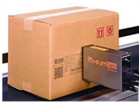
複数のインクジェットプリンタで 板段ボールにGS1 QRコードを印字
