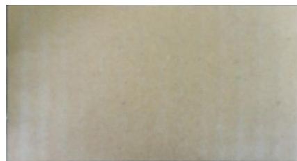
摩擦 1000 回後の 直接印字のインク転移
