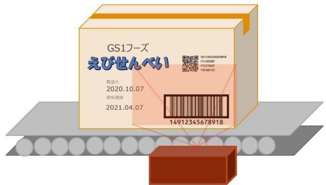
GS1 QRコードがカメラの画角におさまらないおそれがある
