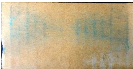
摩擦 1000 回後の フレキシ印刷のインク転移
