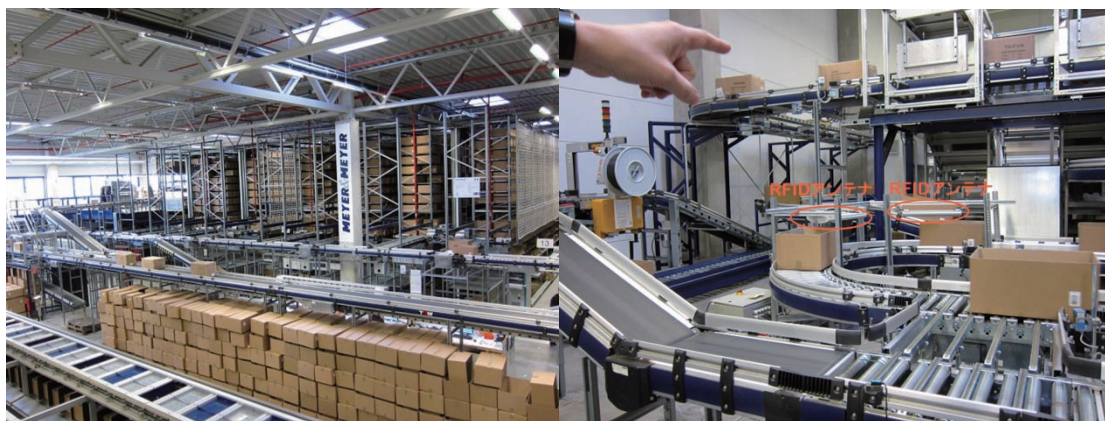
(左) 物流センターの様子 (右) 商品出荷時に電子タグが一括読取りされている様子
